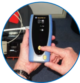
Autotest desde la unidad remoto para pruebas con una sola persona
