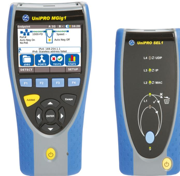
Diseñado para realizar comprobaciones de Ethernet completas en la expansión de servicios de operadora, enlaces de troncal de servicios móviles, enlaces inalámbricos y de microondas, así como para que los usuarios profesionales puedan controlar el cumplimiento del acuerdo de nivel de servicio por parte de las operadoras
