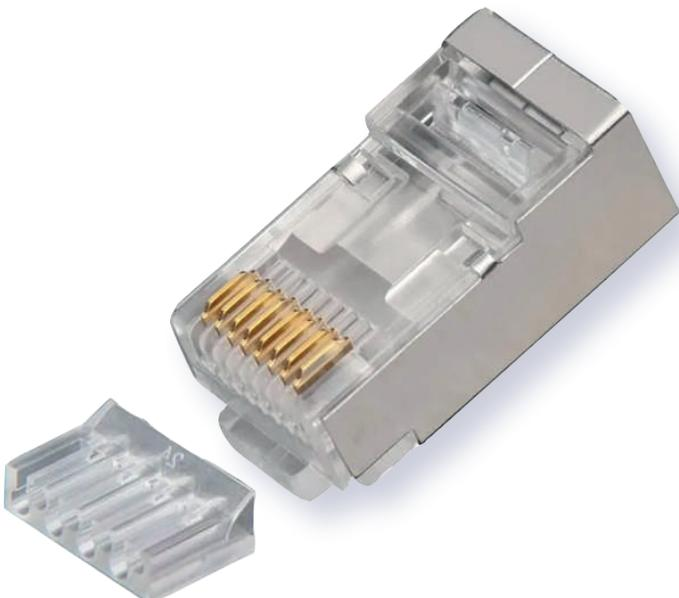
El plug RJ45 de 8 posiciones y 8 contactos CAT 6A, completamente blindado de dos partes, con lengüeta para soldar el conductor de drenaje o malla de aterramiento con contactos de revestimiento dorado y dos puntas descentradas para conductores sólidos AWG 23-26, se utiliza principalmente para hacer cables tipo patch cords con conductores sólidos y cumplen la función de interconectar los Sistemas de Cableado Estructurado tomando como base el estándar de categoría CAT 6A.
